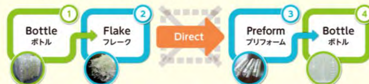
Flake to Preform Direct Recycling F to P ダイレクト リサイクル
